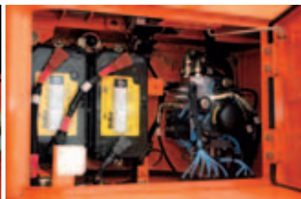
В одном отсеке – АКБ и гидроагрегаты
