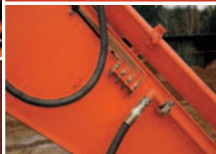
Точки смазки на стреле и рукояти
