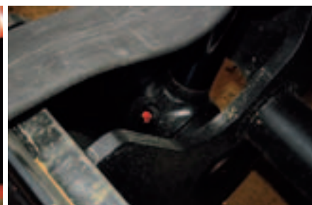
Шарнир отвала защищен резиновым фартуком
