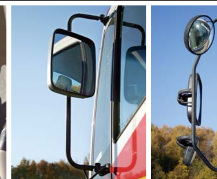
Зеркало со стороны водителя одно, а со стороны пассажира – три
