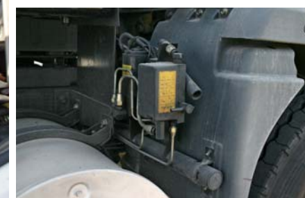
Электрогидравлический подъемник кабины
