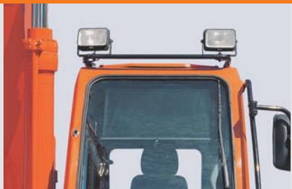
Дополнительное рабочее освещение на кабине
