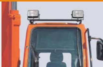
Дополнительное рабочее освещение на кабине
