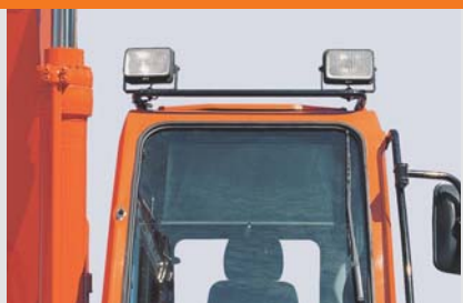
Дополнительное рабочее освещение на кабине
