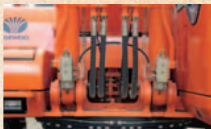
Гидрозамки на цилиндрах стрелы
